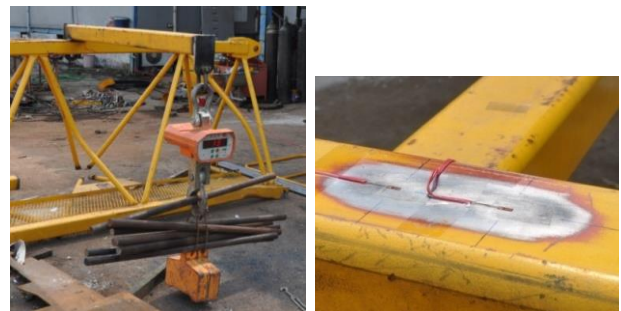
รูปที่2 การวัดค่าความเค้นด้วยเกจวัดความเครียด
