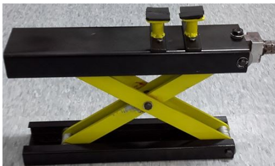
ภาพที่ 6 แม่แรงแบบแอกซ์ลิฟท์
