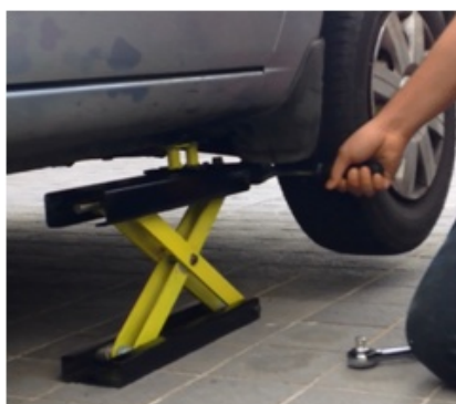
ภาพที่ 7 การใช้แม่แรงแบบแอกซ์ลิฟท์ยกรถยนต์
